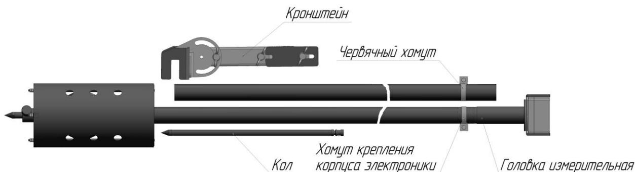
Рисунок 1 – Общий вид ДПА в транспортном положении
